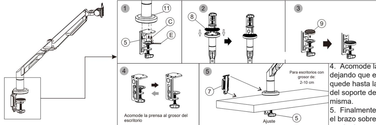
espacio de la prensa, luego con ayuda de la perilla (5), fije el brazo en la superficie asegurándose que esté firme. Puede colocar la cubierta para cable lateral (7) en el soporte de la prensa.
