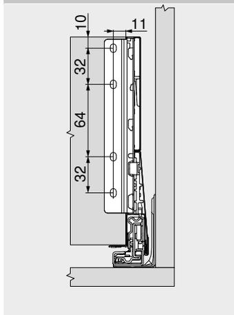
\* +1 mm si las guías de cuerpo se instalan antes de montar el cuerpo
