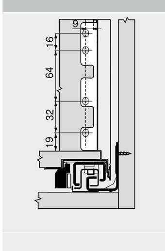
\* +1 mm si las guías de cuerpo se instalan antes de montar el cuerpo
