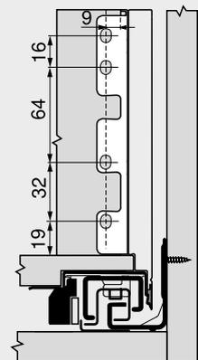
\* +1 mm si las guías de cuerpo se instalan antes de montar el cuerpo
