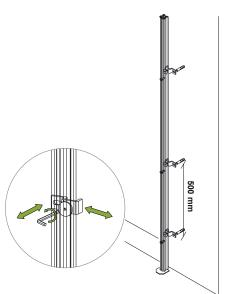
Con la fijación a muro (302.404) atornille a la pared.
