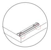
Una vez fijado el clip en el panel, retire las pestañas de plástico del clip.
