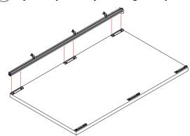
Una vez retiradas las pestañas de plástico, puede enganchar en los clips de plástico el perfil de la estantería en el que ya ha insertado los soportes metálicos.
