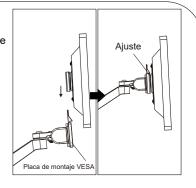
Coloque el monitor sobre el soporte del brazo de arriba hacia abajo y asegúrese que se mantenga fijo
