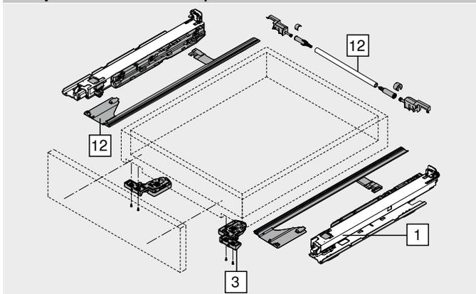
MOVENTO con BLUMOTION – 760H – montaje sobre el fondo del cuerpo – cajón
