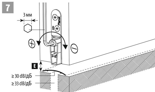
Ajustar la carrera con una llave Allen (3 mm), hasta que el labio de silicona apoye bien en el suelo. Evitar una presión excesiva contra el suelo. (espacio bajo la puerta: ver para el ajuste de carrera)
