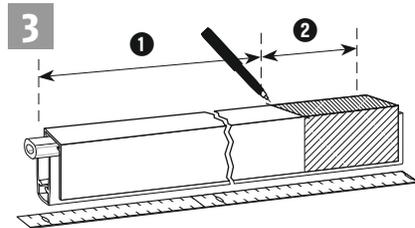
**Acortamiento de Planet:** **1** El Planet debe ser 1-2 mm más corto que el ancho de la hoja; **2** Tramo de corte: hasta la siguiente medida en stock (max. 125 mm)
