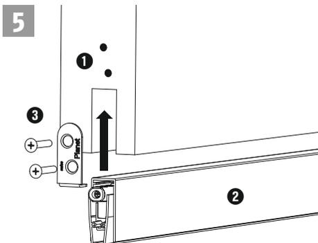
**Montaje del Planet:** **1** Marcar los orificios para los tornillos **2** Embutir el Planet en la ranura **3** Atornillar la escuadra de fijación
