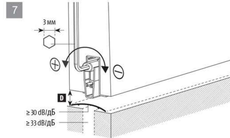
Ajustar la carrera con una llave Allen (3 mm), hasta que el labio de silicona apoye bien en el suelo. Evitar una presión excesiva contra el suelo.
