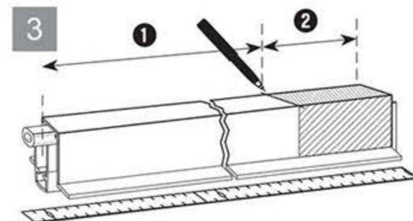
Acortamiento de Sello : 1 El Sello debe ser 1-2 mm más corto que el ancho de la hoja; 2 Tramo de corte: hasta la siguiente medida en stock (max. 120 mm)
