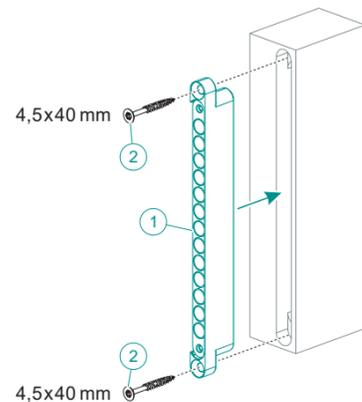
**DE** Den Schließmagneten ① in den Türflügel einsetzen, den Türflügel vorbohren und den Schließmagneten mit den 2 Schrauben ② befestigen.
