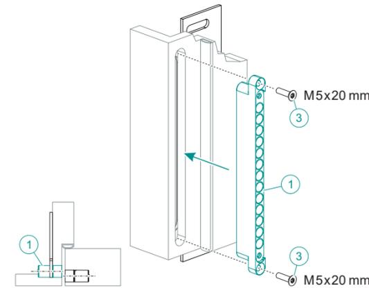
**DE** Zur Stabilisierung rückseitig die Befestigungsplatte (KCM 50 FZ) verschrauben. Den Schließmagneten mit den 2 Schrauben ③ an der Befestigungsplatte befestigen (8 Nm).
