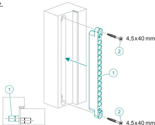
**DE** Den anderen Schließmagneten ① ausrichten und in die Zarge einsetzen, die Zarge vorbohren und den Schließmagneten mit den 2 Schrauben ② befestigen.
