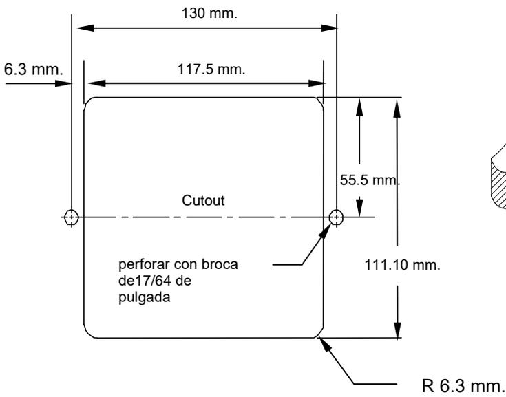
Para cubiertas de hasta 31 mm.
